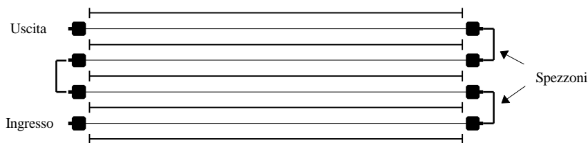
Figura IV.4: modalità con la quale sono state collegate in serie più celle, in questo caso 4.
